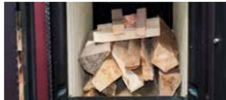
Befüllen Sie den Feuerraum mit liegenden Holzscheiten und einer Auflagemenge wie in der Anleitung beschrieben.
